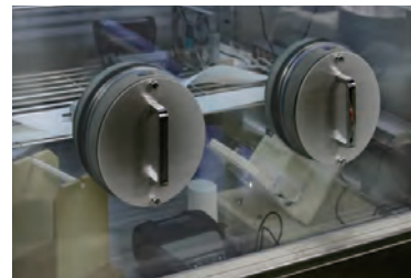
恒温槽による温度環境試験
