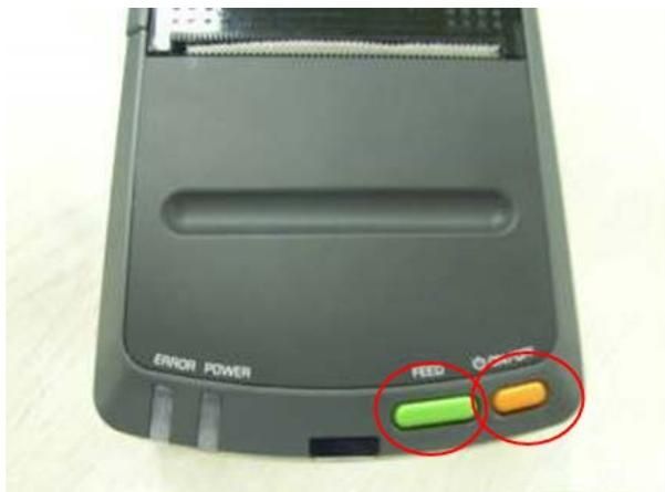
3. **ON/OFF** スイッチ(橙)と **FEED** スイッチ(緑)を同時に約 6 秒、押し続けます。
