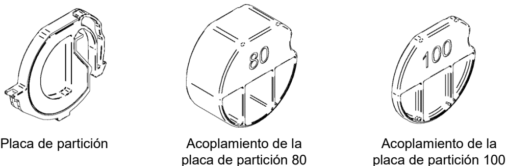
Figura 13-1 Placa de partición y acoplamientos
