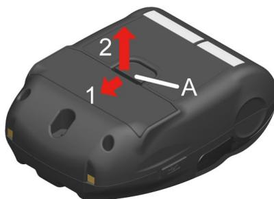
Figura 15-1 Retirada de la batería (1)
