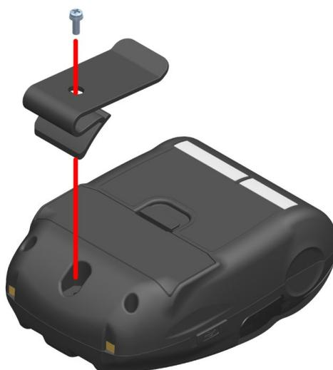
Figura 13-1 Sujeción/Retirada del clip de cinturón
