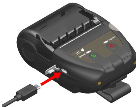
Illustration 8-1 Branchement du câble USB à l'imprimante
