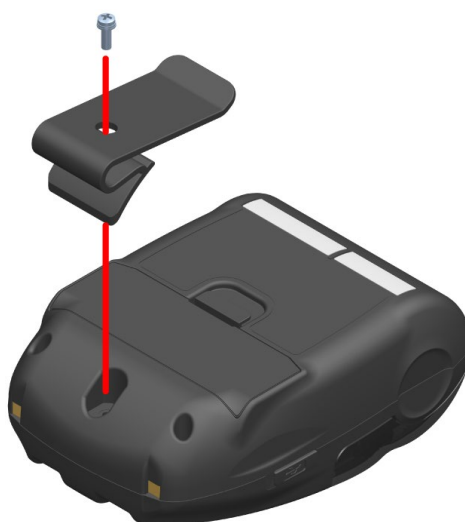
Illustration 13-1 Attacher/Détacher le clip de ceinture
