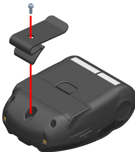
Figura 13-1 Montaggio/smontaggio della clip da cintura
