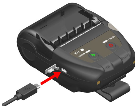
Figura 8-1 Collegamento stampante e cavo USB
