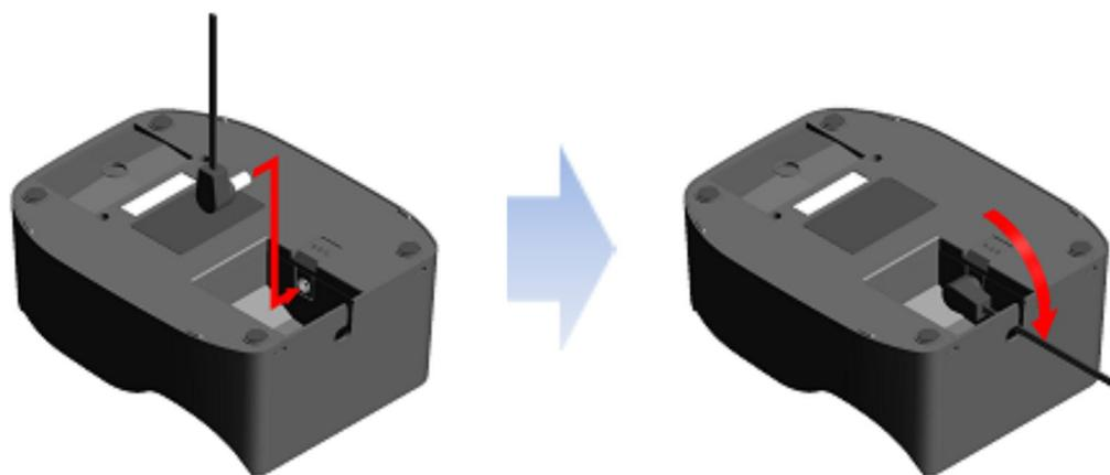
図 17-2 クレードルとACアダプタの接続
