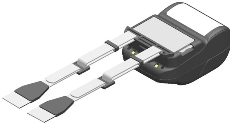
図 15-9 ショルダストラップの取り付け(5)
