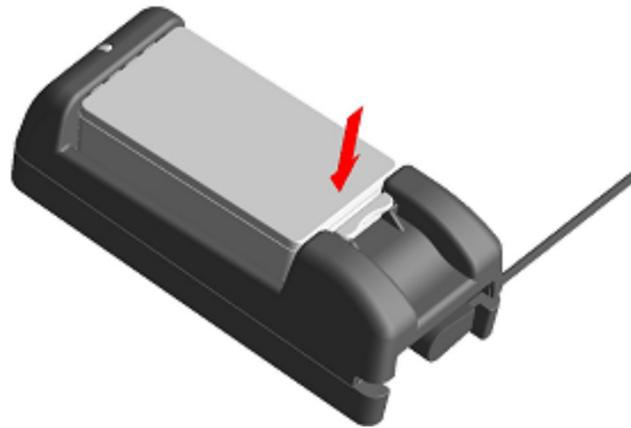
図 19-6 バッテリーパックの充電器への取り付け (2)
