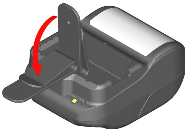
図 15-2 ベルトクリップの取り付け(2)
