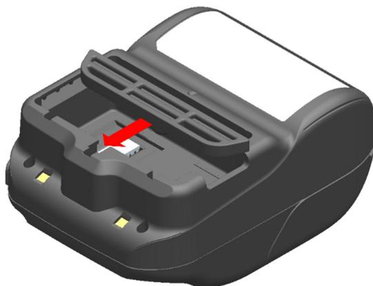
図 15-5 ショルダストラップの取り付け(1)
