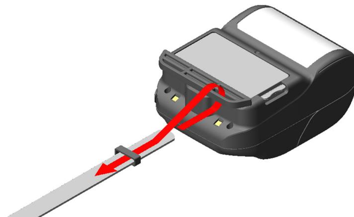
図 15-7 ショルダストラップの取り付け(3)
