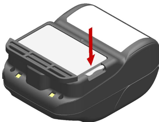
図 15-6 ショルダストラップの取り付け(2)
