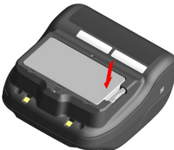
**Figura 8-3 Installazione della batteria (2)**
