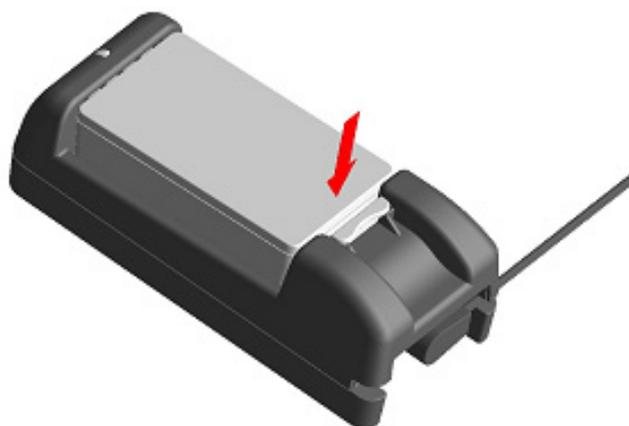
**Figura 17-6 Inserimento della batteria (2)**
