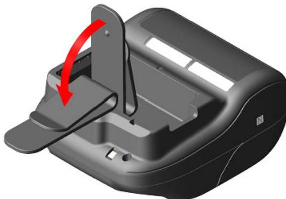
Figura 13-2 Installazione della clip da cintura (2)
