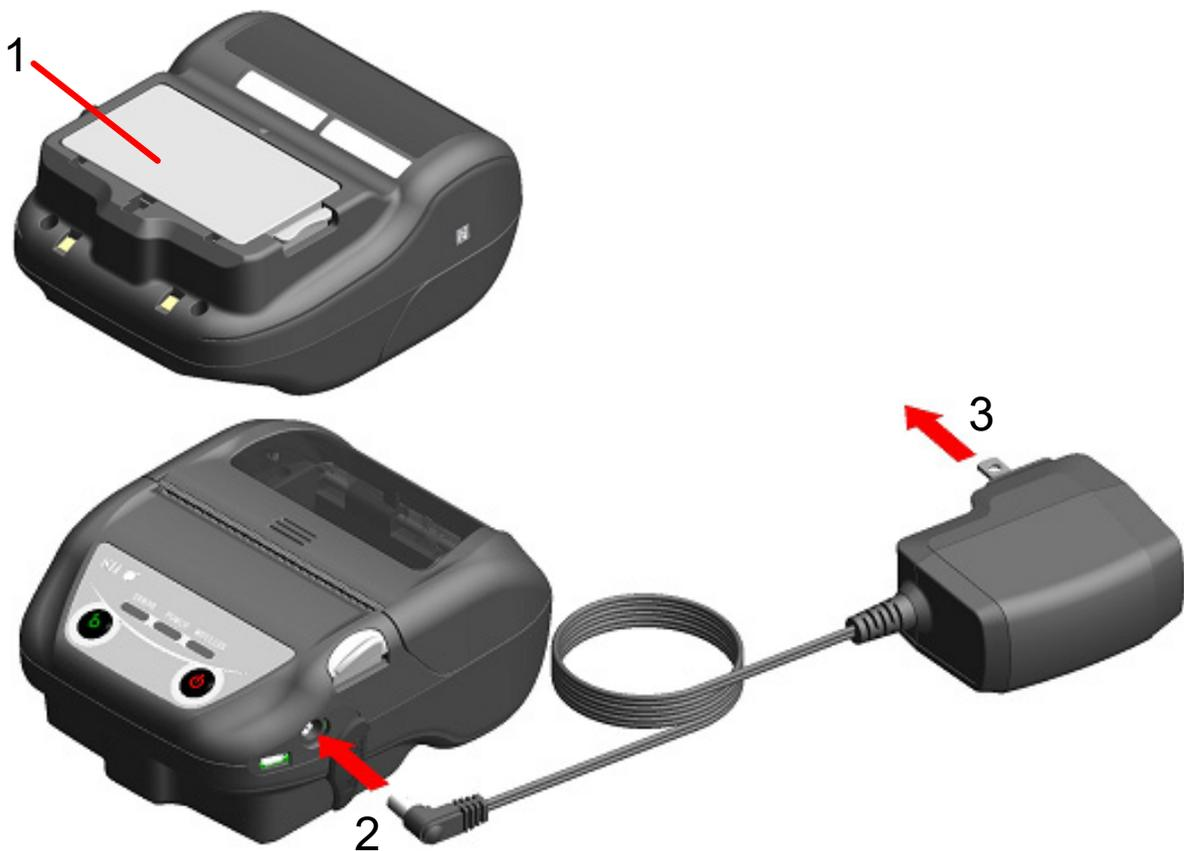
**Figura 14-2 Carica in modalità di carica con stampante spenta mediante adattatore CA**
