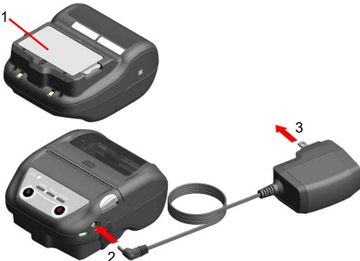
図 14-2 ACアダプタによるパワーオフ充電モードでの充電
