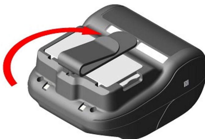
図 13-4 ベルトクリップの取り付け(4)
