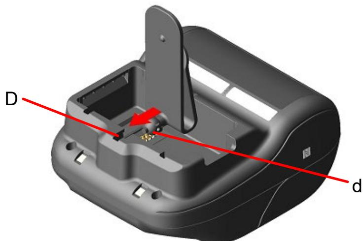
図 13-1 ベルトクリップの取り付け(1)
