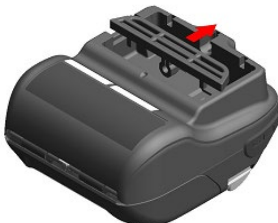
図 13-5 ショルダストラップの取り付け(1)
