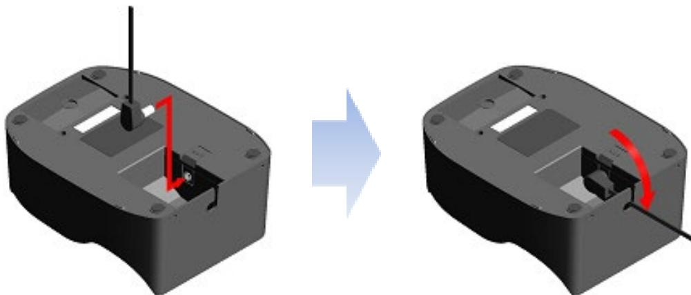
図 15-2 クレードルとACアダプタの接続
