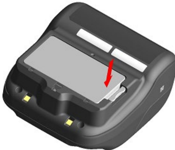
図 8-3 バッテリーパックの取り付け(2)
