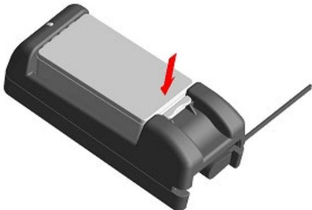
図 17-6 バッテリパックの充電器への取り付け (2)
