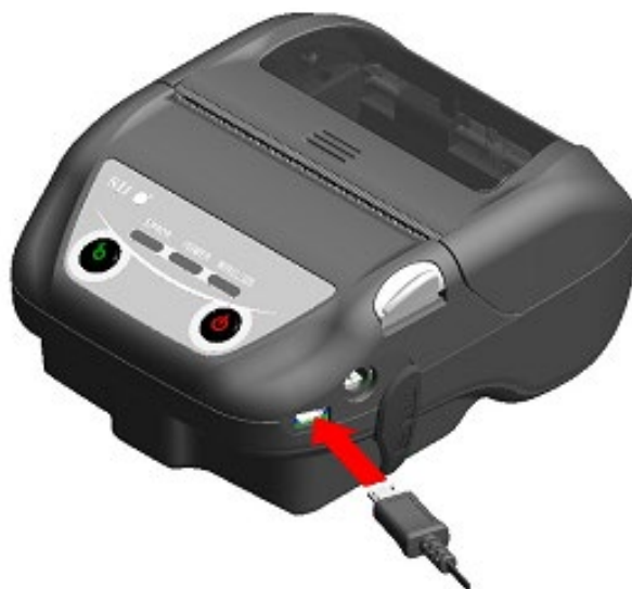
図 12-1 プリンタとUSBケーブルの接続
