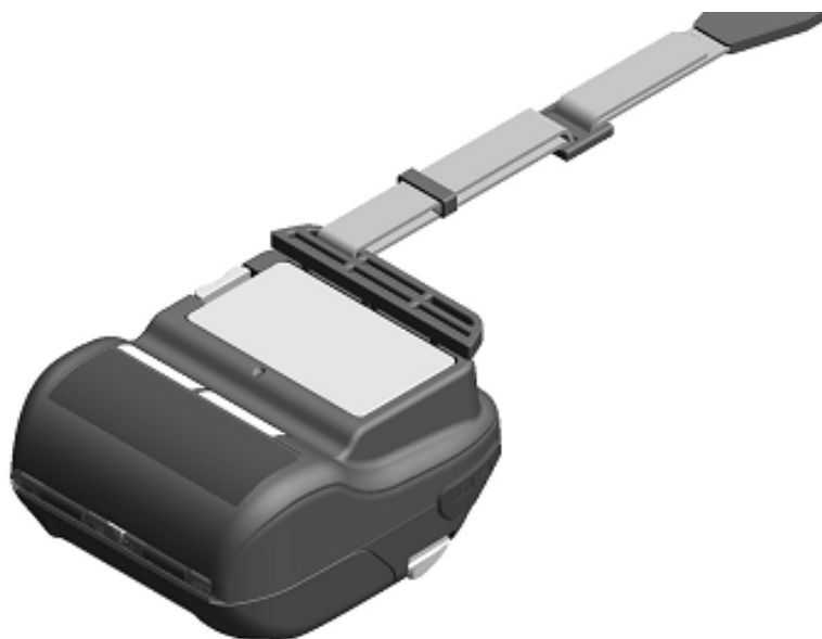
図 13-8 ショルダストラップの取り付け (4)
