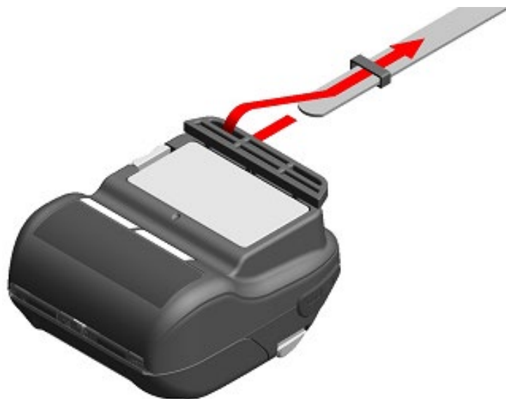
図 13-7 ショルダストラップの取り付け (3)
