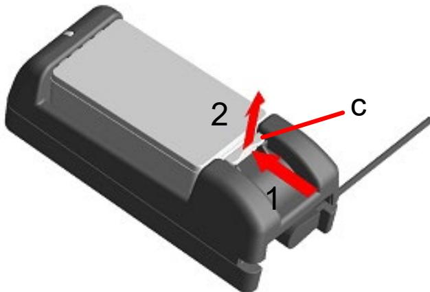
図 17-7 バッテリパックの充電器からの取り外し
