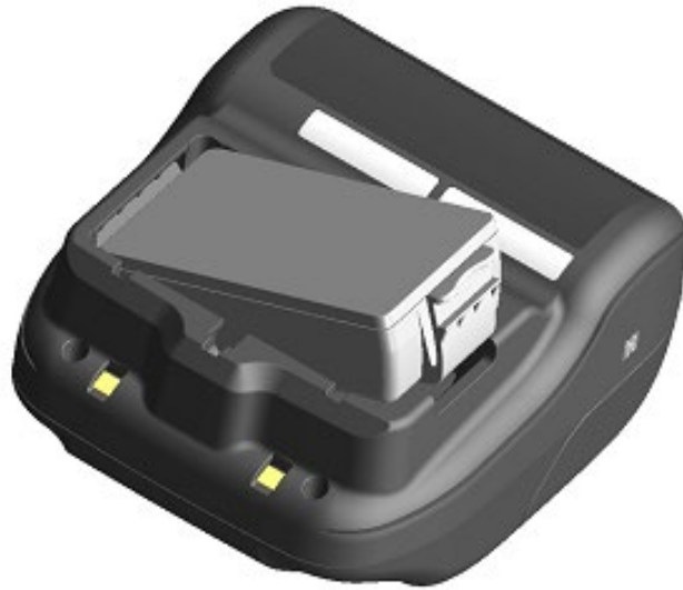
図 8-2 バッテリーパックの取り付け(1)
