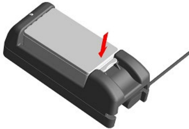
図 17-6 バッテリーパックの充電器への取り付け (2)
