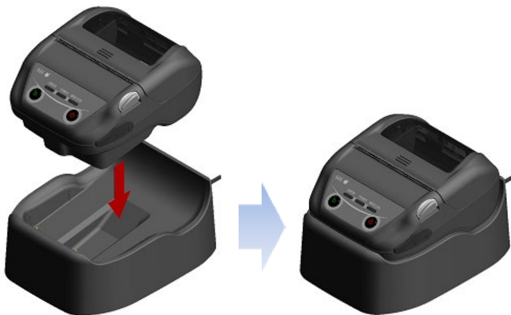
図 15-3 プリンタとクレードルの接続
