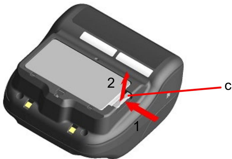
図 8-4 バッテリパックの取り外し
