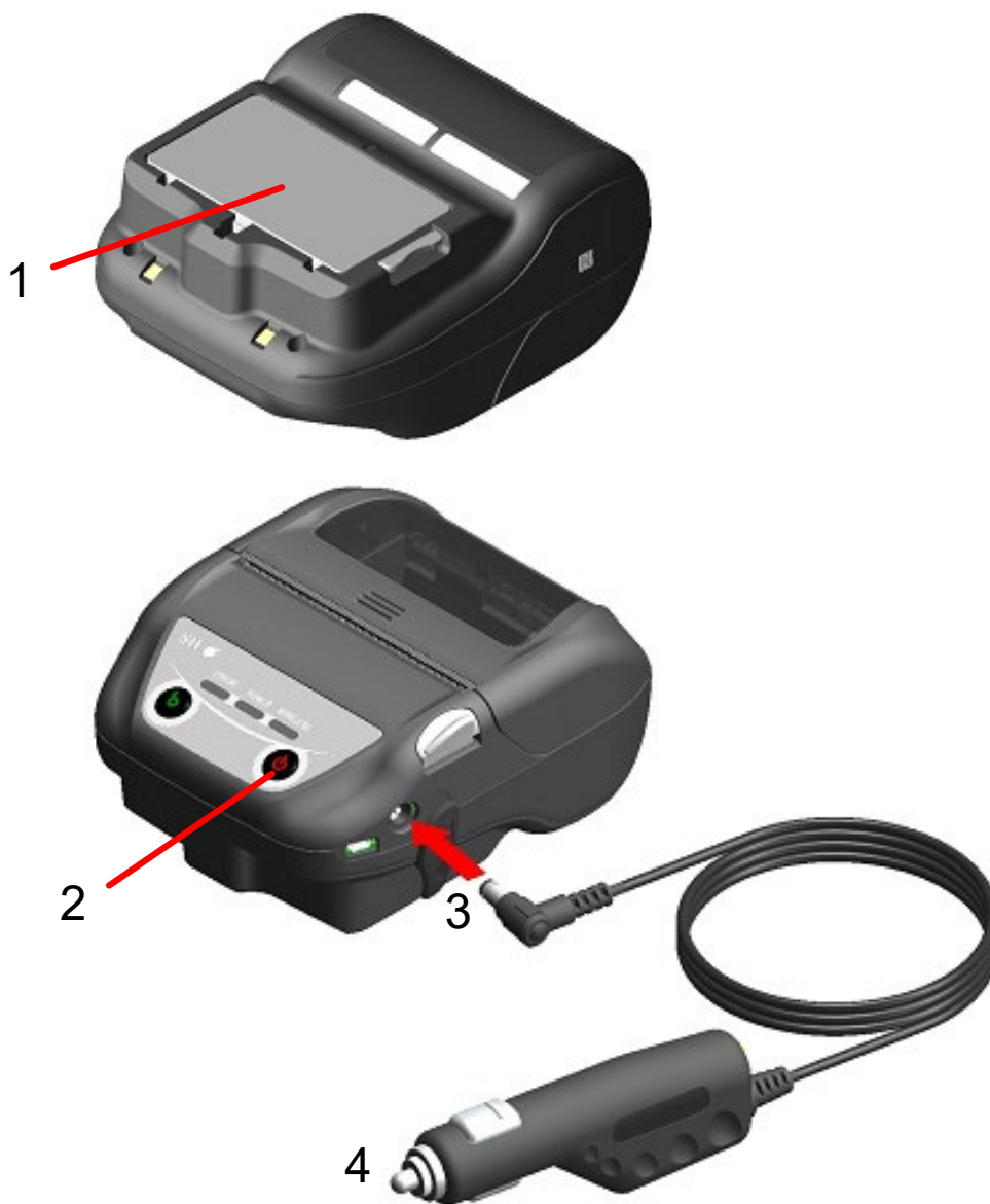
図 16-2 カーチャージャによるパワーオン充電モードでの充電
