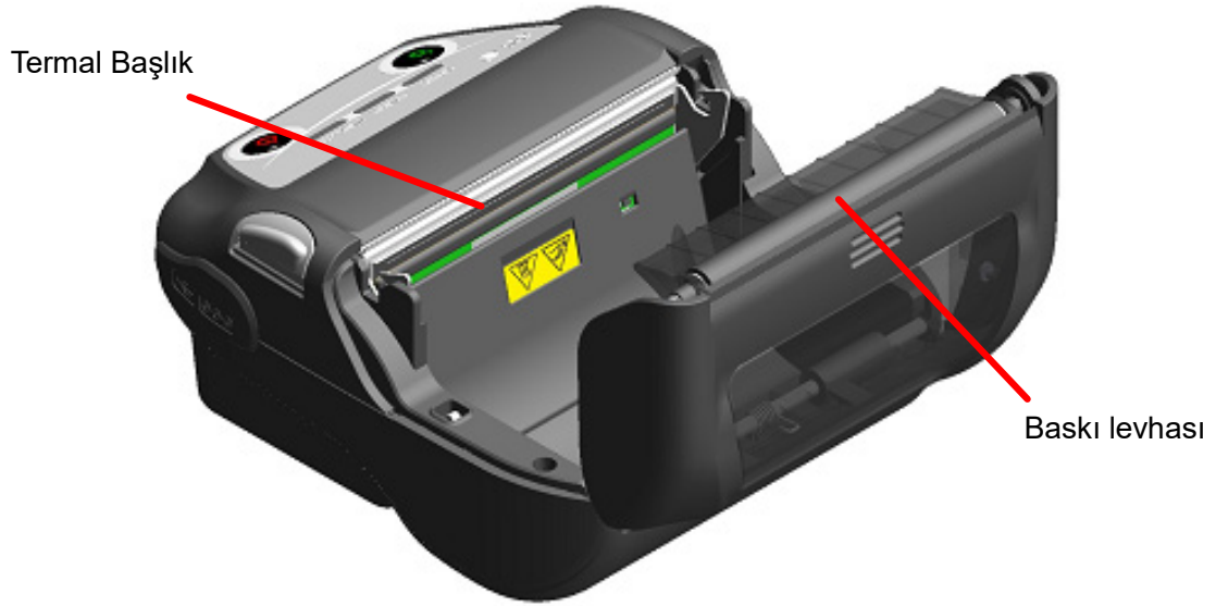
Şekil 18-1 Termal Başlığın/Baskı Levhasının Temizlenmesi
