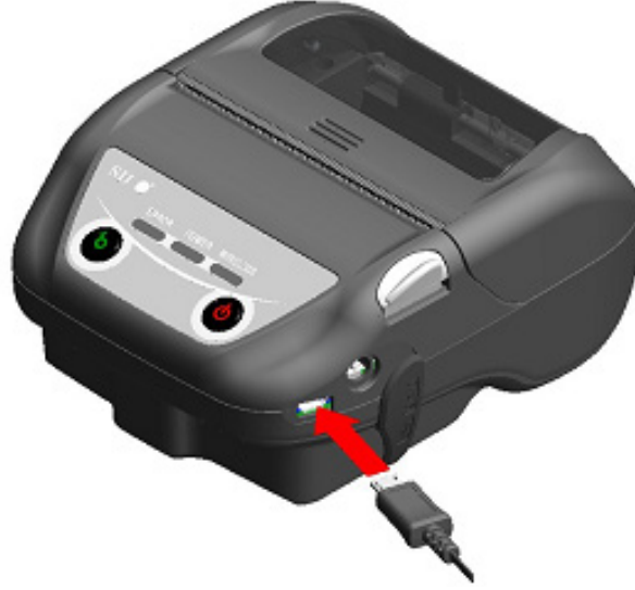
Şekil 12-1 Yazıcı ve USB Kablosu Bağlantısı
