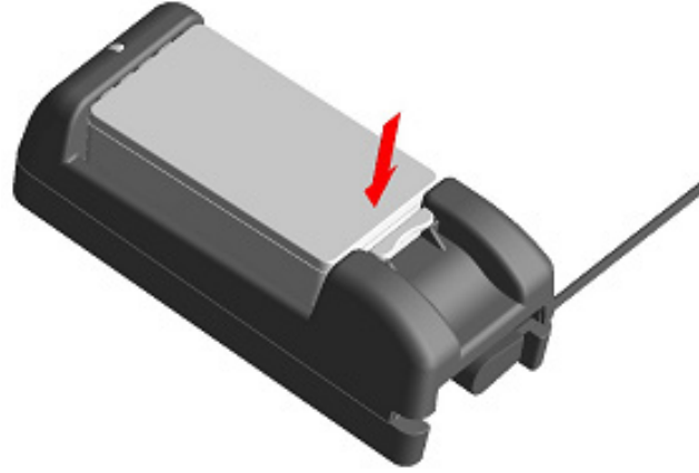
Şekil 17-6 Pil Takımının Takılması (2)
