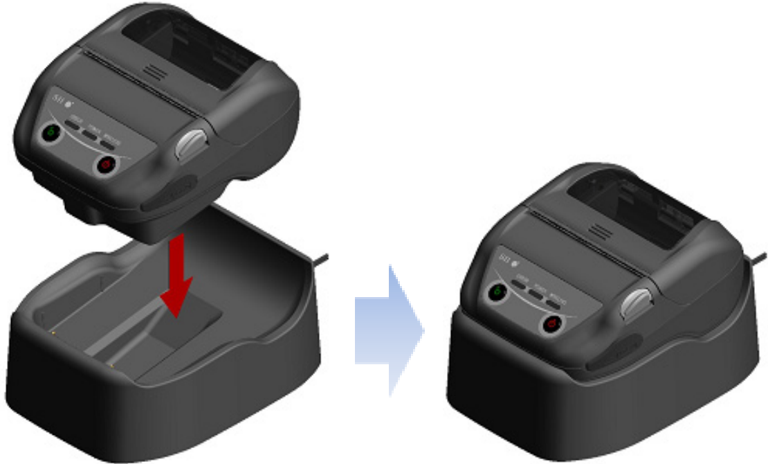
Şekil 15-3 Yazıcı ve Yuva Bağlantısı
