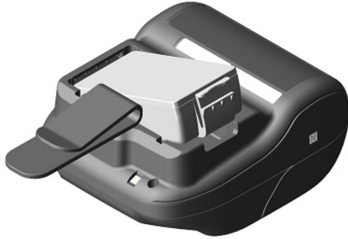
Şekil 13-3 Kemer Tutucunun Takılması (3)
