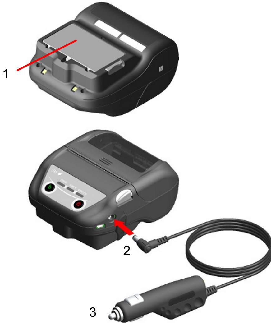
Şekil 16-3 Araç Şarj Cihazıyla Güç Kapalı Şarj Modunda Şarj Etme
