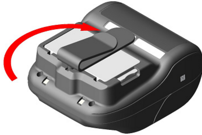
Şekil 13-4 Kemer Tutucunun Takılması (4)
