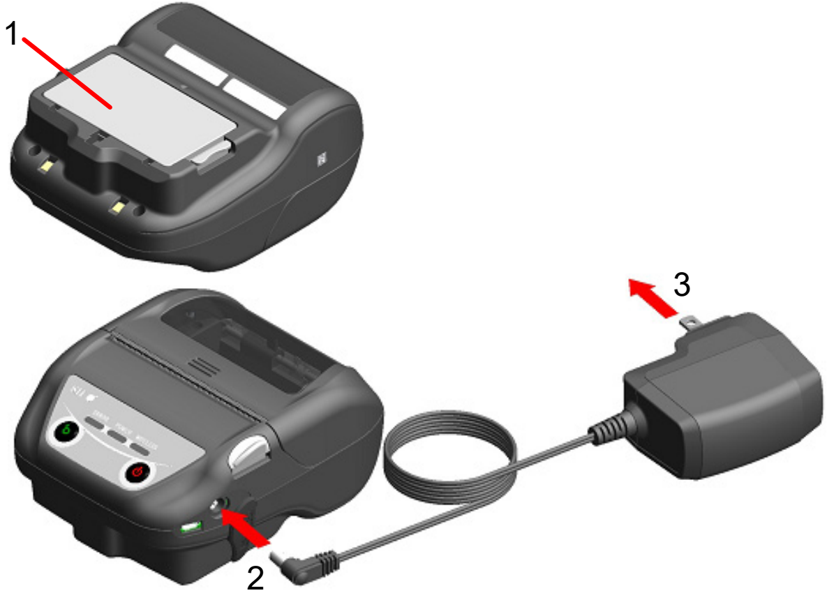
Şekil 14-2 AC adaptörüyle Güç Kapalı Şarj Modunda Şarj Etme
