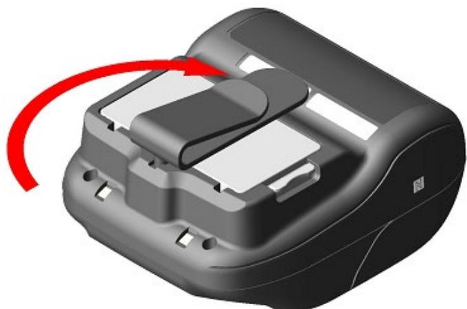
図 15-4 ベルトクリップの取り付け(4)
