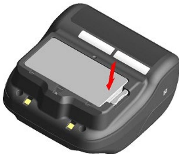
図 8-3 バッテリパックの取り付け(2)
