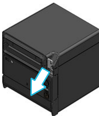
Figura 8-2 Alavanca de liberação (ejeção frontal)
