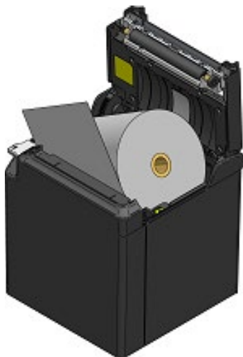
Figura 8-5 Estado de colocação de papel térmico (ejeção superior)
