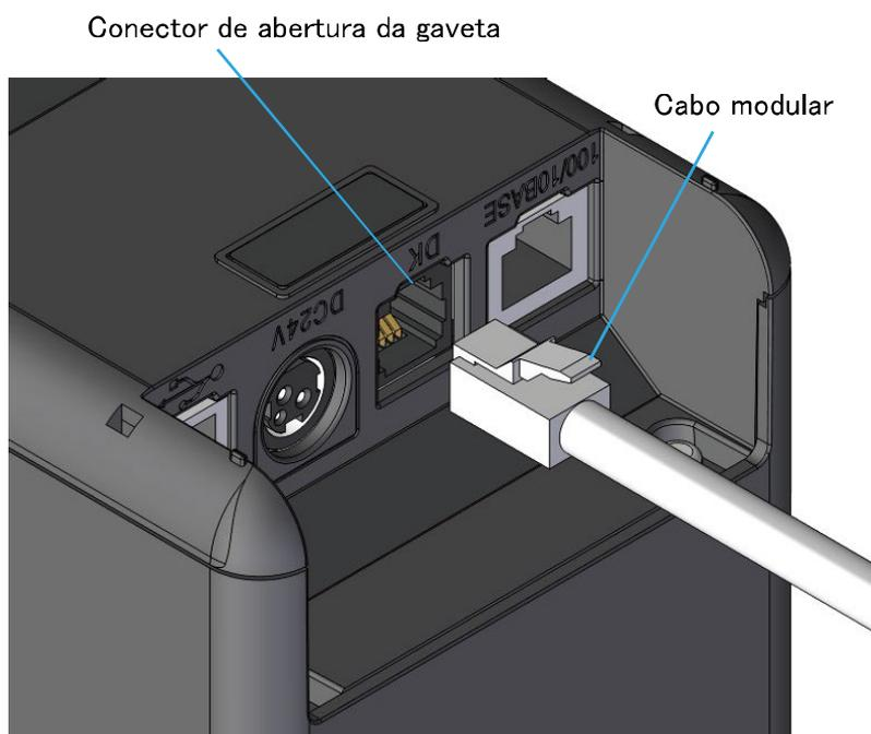
**Figura 13-1 Ligação do cabo modular à impressora**
