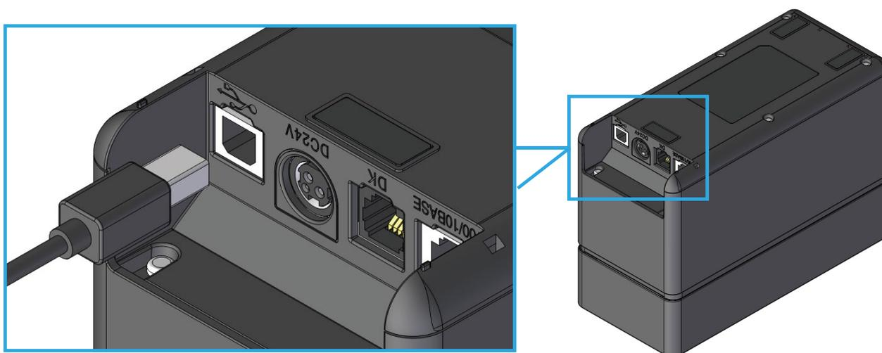
Figura 12-1 Ligação da impressora e do cabo USB
