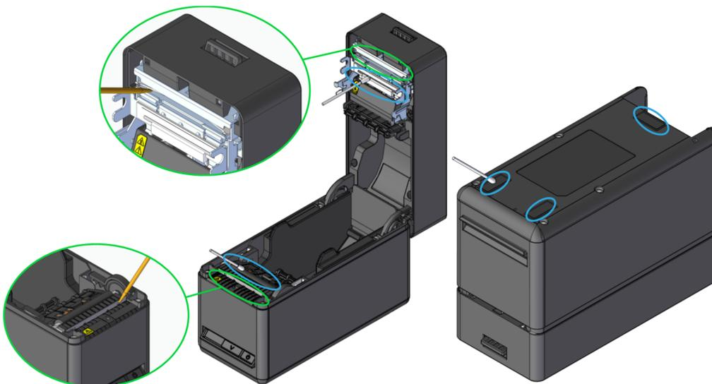
Figura 14-1 Limpeza da cabeça térmica/cilindro/pés de borracha/cortador
