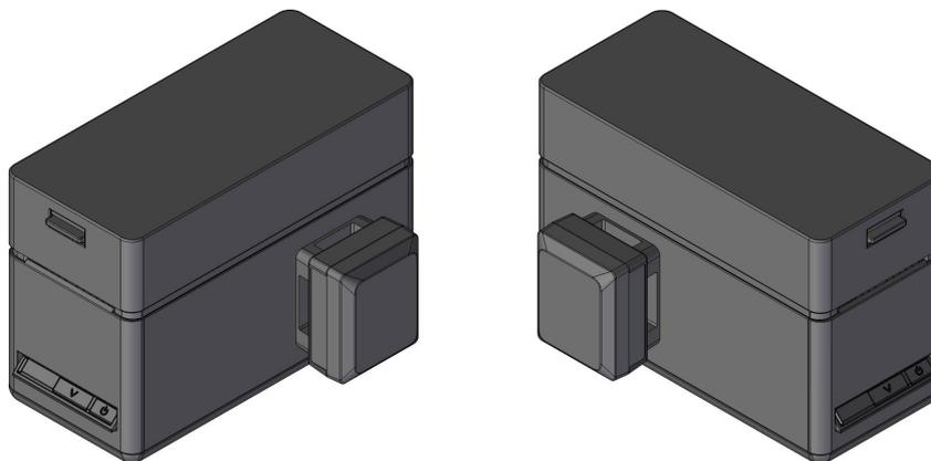
**Figura 13-4 Exemplo de posição de instalação do sinalizador externo**
