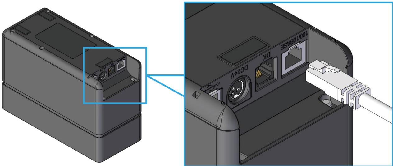
**Figura 12-2** Ligação da impressora e do cabo Ethernet
