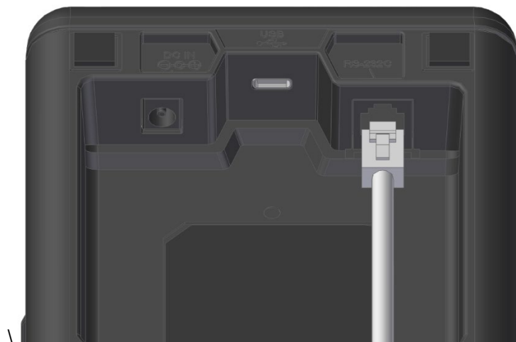
Figura 12-2 Conexión de la impresora y el cable serie
